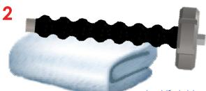
توسط یک پارچه رسوبات فلزی چسبیده به بدنه آهن ربا را بطور کامل جدا نمایید. (شکل۲)
