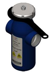
بازدید و سرویس دوره ای فیلتر مغناطیسی موتورخانه، بصورت سالانه توصیه می گردد. پس از نصب اولیه، بازدید پس از یک ماه توصیه می گردد. به منظور ســرویس فیلتر ،Dual Mag پس از اطمینان از امن و مناســب بودن محل سرویس، در صورت عدم نصب مسیـر بای یس، ابتدا دیگ/ چیـلر را خاموش کــــرده و اجازه دهید دمای آب داخل مدار ، در حد دمای محیط، خنک شود. حتی در صورت نصب فیلتر بصورت بای پس، پس از خروج فیلتـر از مدار، اجازه دهید آب درون فیلتر برای جلوگیـری از آسیب و سوختـگی، به حد کافی خنک شود.
